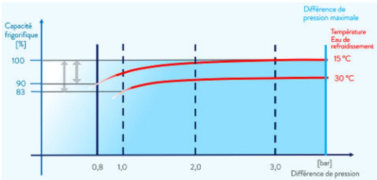
Fig. 13 : Différence de pression d'eau de refroidissement
