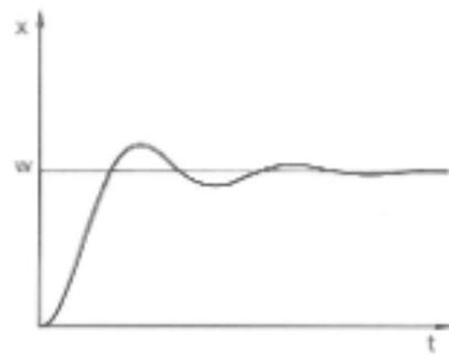
Fig. 55 : Paramètres de réglage  $T_n$  et  $T_v$  trop petits
