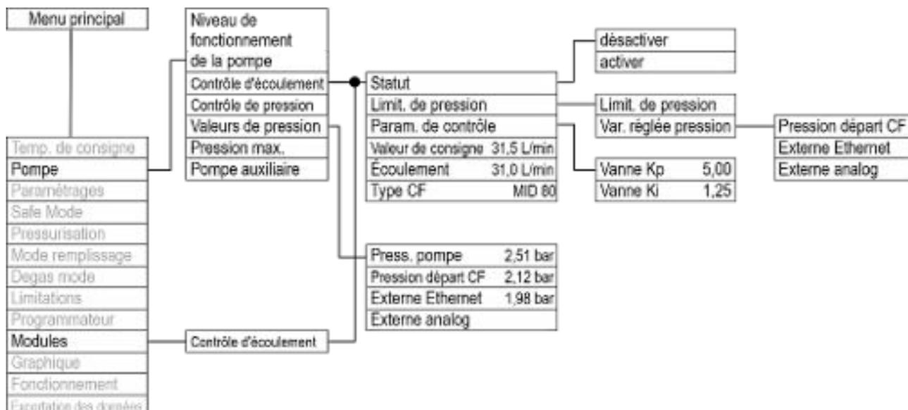
Fig. 46 : Menu de commande du régulateur de débit dans l'appareil Integral XT
