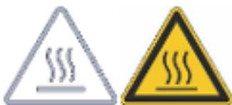
Le symbole graphique « Surfaces chaudes » est apposé sur l'appareil. Ce symbole attire l'attention sur les surfaces brûlantes de l'appareil. Tout contact avec ces surfaces est interdit durant le fonctionnement. Avant de toucher ces surfaces pour des interventions telles que la maintenance, ces surfaces doivent avoir refroidi à la température de la pièce.
