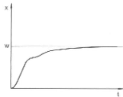
Fig. 56 : Paramètres de réglage  $T_n$  et  $T_v$  trop grands
