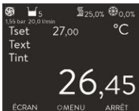
Fig. 45 : Fenêtre de base Integral XT et Integral P avec régulation du débit
