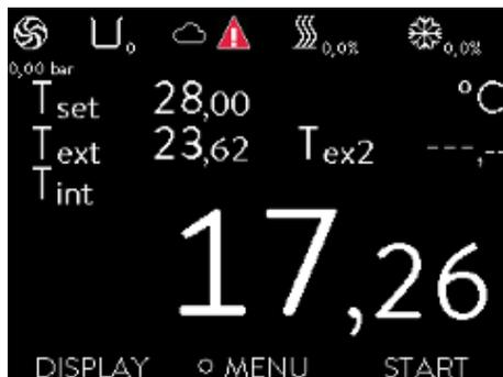
Fig. 74 : Fenêtre de base avec un nuage dans la barre d'état
